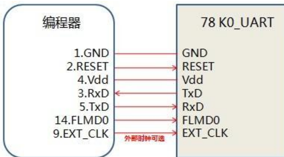
图 3：78K0 系列 UART 模式连接示例
